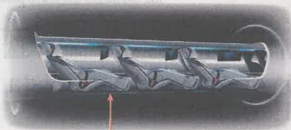
3. El cojín de aire se consigue gracias a una turbina en el morro de la cápsula, que comprime el aire que se va encontrando a su paso y lo redirecciona hacia la parte inferior y posterior del aparato
